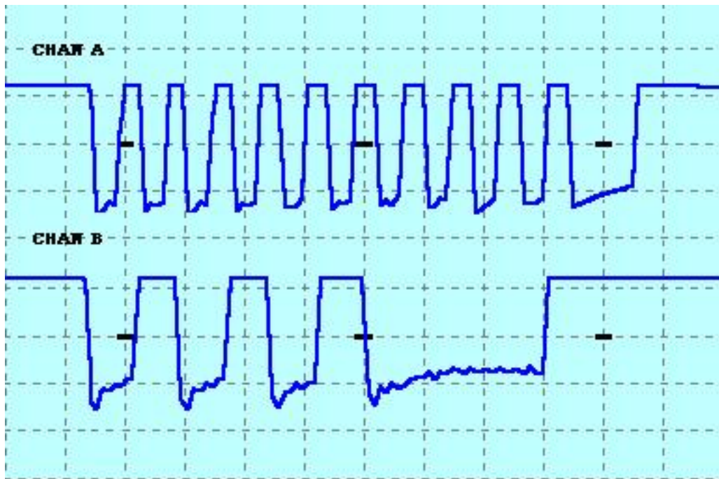
图 2-8: PS/2 传输 Q 键扫描码 (15h) 波形图
